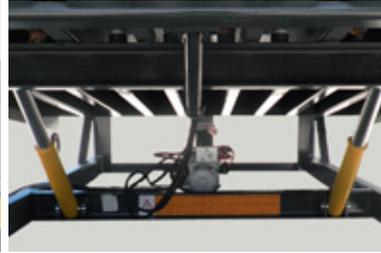
Die Vorschubbrücken **RH2 und RH3** sind mit Hubzylindern ausgestattet, deren Kolben einen Durchmesser von 50 mm haben.
