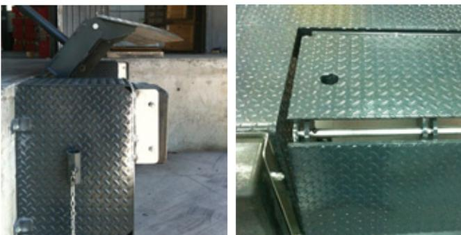
Ihr innerer Mechanismus ermöglicht es dem Benutzer, sie mühelos zu öffnen. Man muss einfach nur ihren Bedienhebel in das dafür vorgesehene Loch des beweglichen Teils anbringen und dann daran ziehen, bis sich die bewegliche Schwenkbrücke in vollständig vertikaler Position befindet. Danach führt man die Lippe mit dem Hebel nach vorne, so daß sie sich mühelos auf den LKW auflegen kann.
