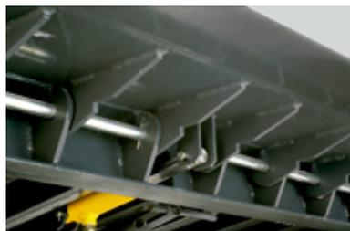
Verstärkte selbstreinigende Scharniere.
